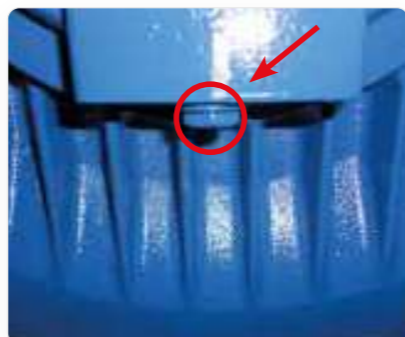
■ Posizione tappo/vite di scarico
