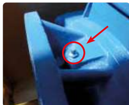
■ Posizione ingrassatore lato comando
