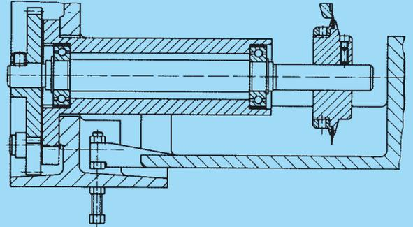
Wälzlager einbau mit Toleranzhülsen Modell AN in der Sackzuführung von Industrienähmaschinen.
