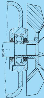
Kombinierte axiale und radiale Befestigung eines Lüfterflügels und gleichzeitiger axialer Festlegung des Wälzlagers mit einer Toleranzhülse.
