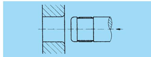
Freier Einbau, Form BN. Die Hülse wird um die glatte Welle herumgelegt, wobei sie an einer Hilfs-Anlagefläche (x) anliegen muss, um sich an derselben entgegen der Einpressrichtung abstützen zu können.
