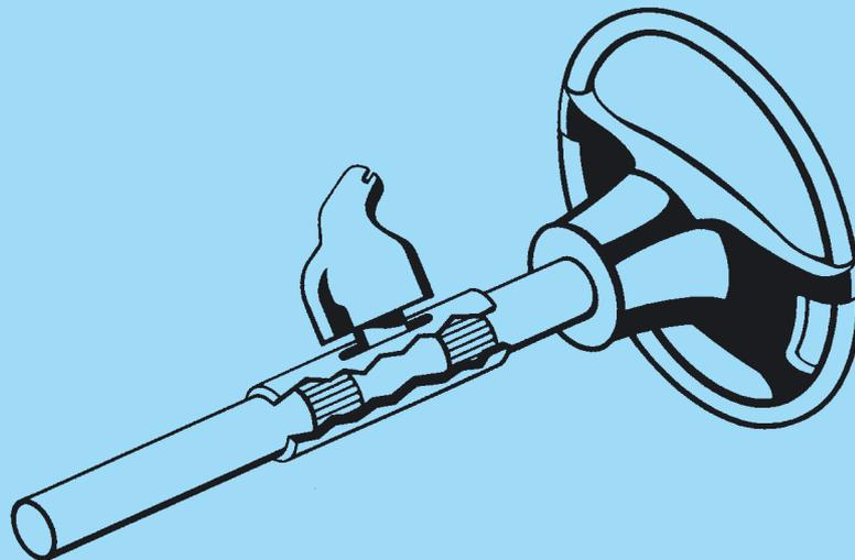
Bei obiger Darstellung der Diebstahlsicherung von Automobilen werden Toleranzhülsen als Rutschkupplung verwendet. Beim Versuch durch Reißen am Lenkrad den Schließbolzen abzurechen, rutscht die Lenkspindel durch. Andererseits ist das Drehmoment zu hoch, als dass man das Fahrzeug lenken könnte.
