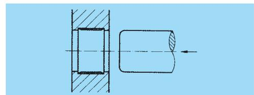
Freier Einbau, Form AN. Die Hülse wird in die glatte Bohrung eingesetzt und zwar so, dass sie sich an einer Hilfsanlagefläche (x) entgegen der Einpressrichtung der Welle abstützen kann.
