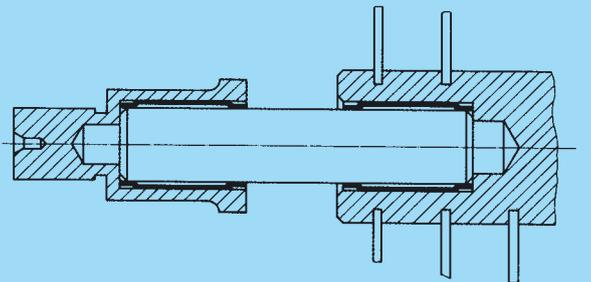
Der Rotor eines Drehkondensators ist durch eine Keramikbuchse isoliert gelagert, die mit Toleranzhülsen befestigt wird.
