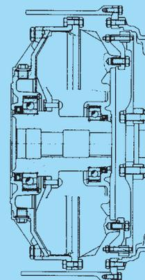
Mit Toleranzhülsen Form AN in eine Turbo-Kupplung eingebaute Rillenkugellager für Betriebstemperaturen mit Spitzen bis 170°C. (Ausgleich der verschiedenen Wärmedehnungen der Al-Gehäuse und Si-Wälzlager.)
