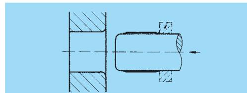
Zentrierter Einbau, Form AN. Die Hülse wird in die Gehäuse eingesetzt und dann die Welle, rechtwinklig zur Nut, eingepresst.
