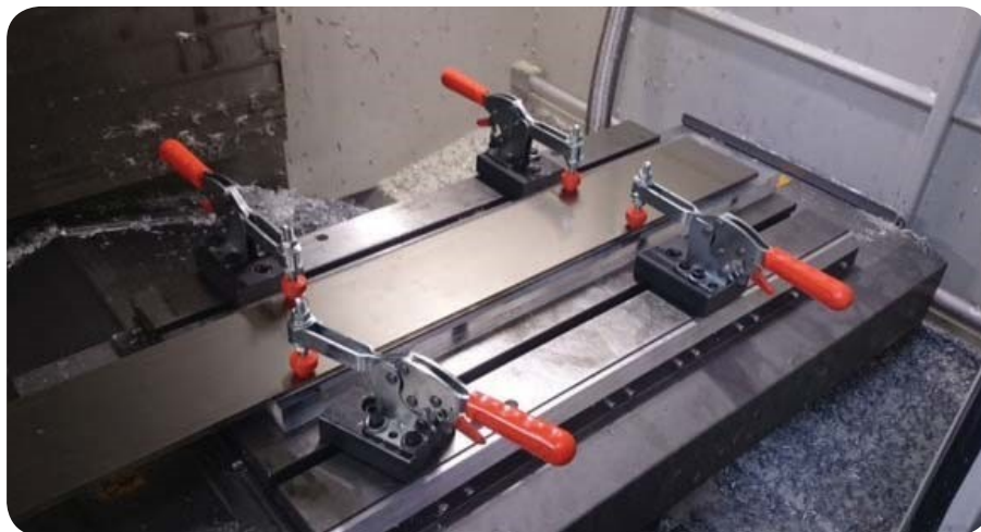
Befestigungsart : mit waagrechtem Fuß Body Mounting Base: Horizontal
